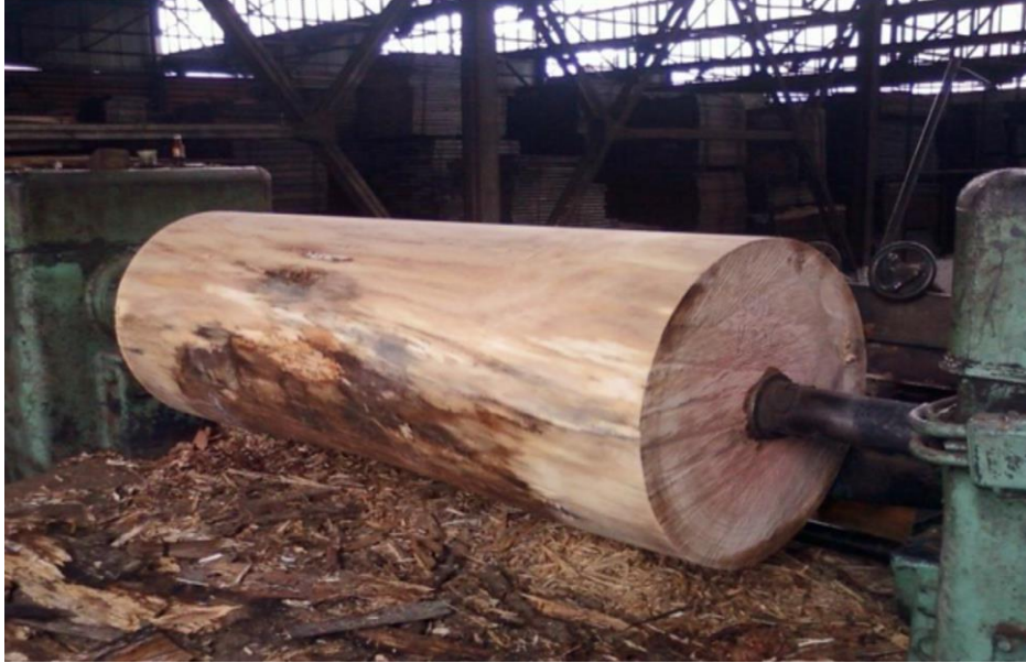
Figure 4 : Déroulage d'une grume
