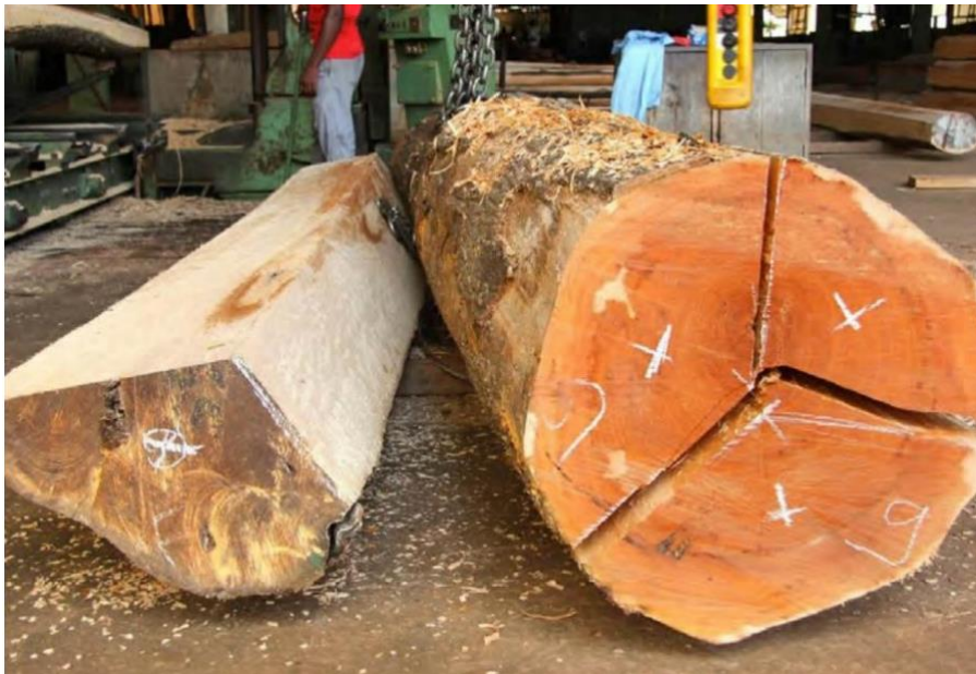
Figure 3 : Équarris issus du sciage de grumes
